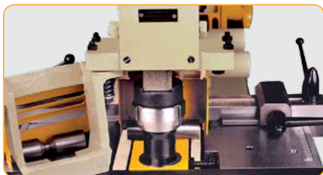
Equipo de punzonado hasta B 36x8 mm de espesor
