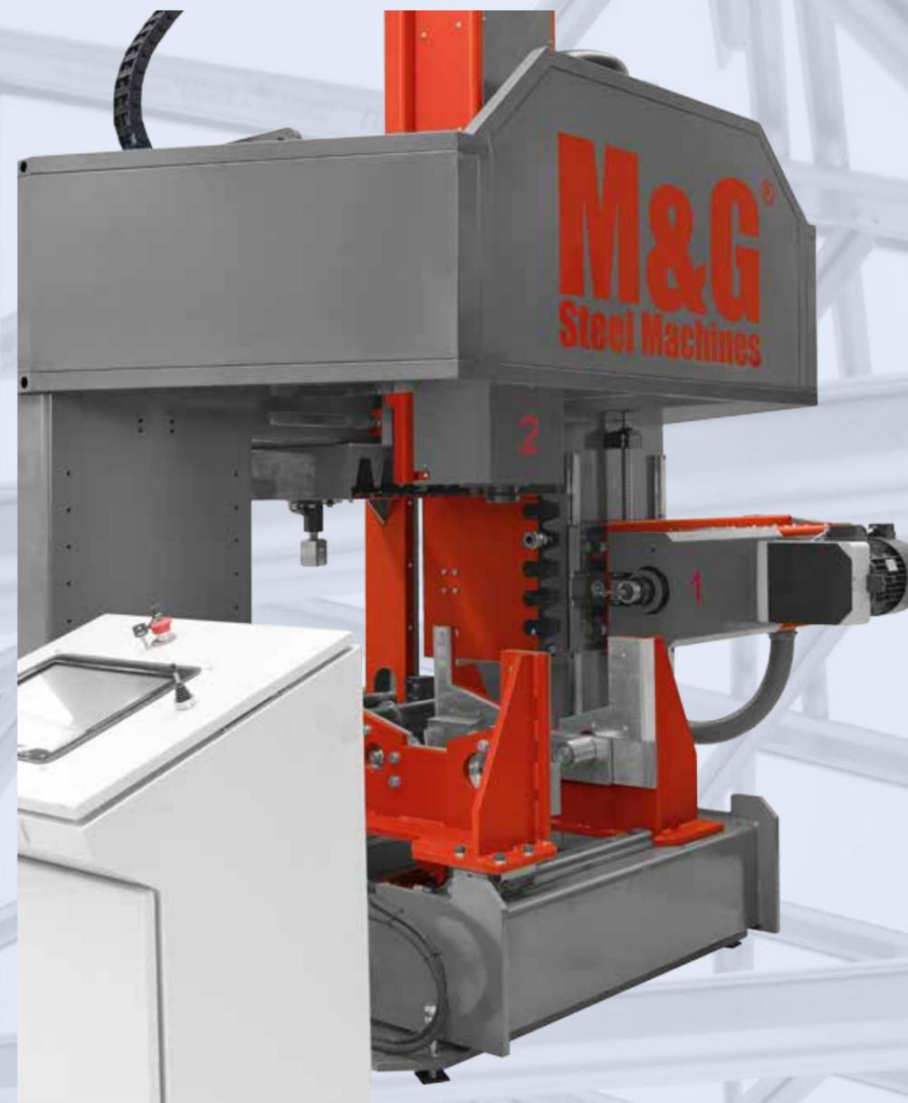
A M&G 2 é desenhada especialmente para a furação e corte de barras e cantoneiras, possíveis no plano horizontal e vertical. O seu design inovador permite dimensões atrativamente reduzidas, diminuindo os tempos de movimentação dos eixos e consequentemente a velocidade do processamento global.
